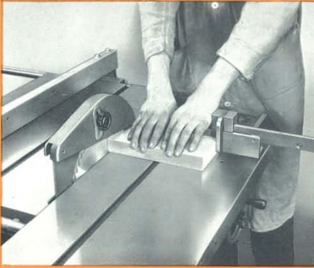
**STRAIGHT CROSS CUTTING USING FIXED FENCE ON SLIDING TABLE**
